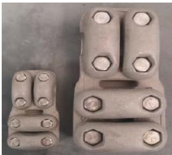
Sl. 1.: Stezaljke za vodiče HTLS za smanjenu skalu ispitivanja (lijevo) i originalnu skalu ispitivanja (desno) koje su korištene za izvođenje ispitivanja [1]
